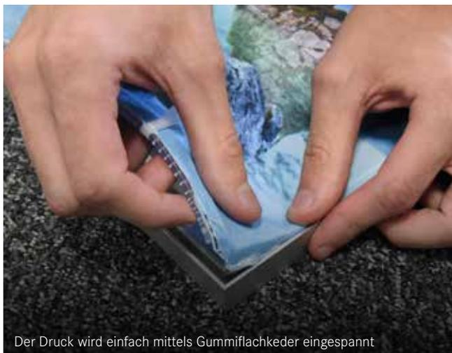
Der Druck wird einfach mittels Gummiflächkeder eingespannt
